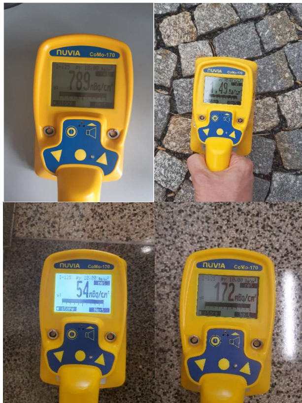
Obrázek 1. Měření přírodního pozadí radionuklidů ve stavebních materiálech v ÚOCHB. Vlevo nahoře – keramický laboratorní stůl, vpravo nahoře – žulové kostky, dole – chodba, různý povrch
