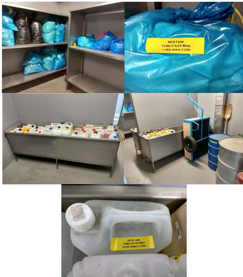
Obrázek 3: Skladování RAO v meziskladu ÚOCHB; separace v souladu se schválenými Provozními předpisy
